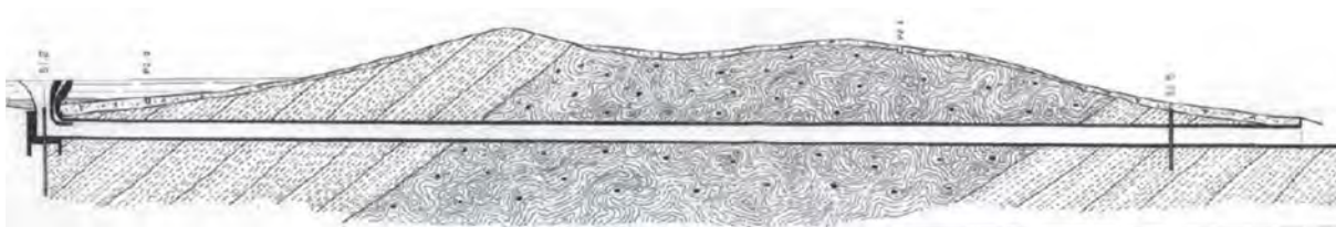
Figura 4.6: Progetto 1978-1980 – Profilo geologico della galleria di scarico di superficie sinistro
